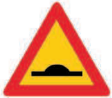
(K - 10) Επικίνδυνα υπερυψωμένο οδόστρωμα ή απότομη κυρτή αλλαγή της κατά μήκος κλίσης της οδού.
