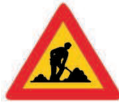
(K - 20) Κίνδυνος λόγω εκτελουμένων εργασιών στην οδό.
