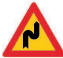
(Κ - 2δ) Επικίνδυνες δύο αντίρροπες ή διαδοχικές (συνεχείς) στροφές- η πρώτη δεξιά.
