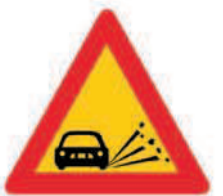
(K - 13) Επικίνδυνη εκτίναξη χαλίκων, (ασύνδετο αμμοχάλικο).
